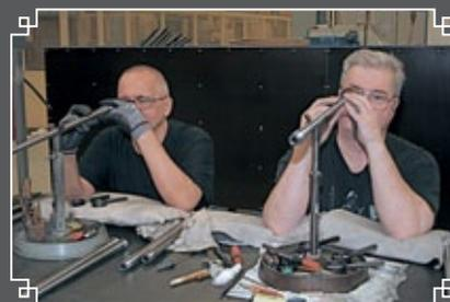
Sako прошла долгий путь со времён скромного начала. Сегодня наш отдел дизайна полностью компьютеризирован, все стальные детали изготавливаются по последним требованиям на станках с ЧПУ. Некоторые вещи не изменились: мы проверяем стволы человеческим глазом, и мы отстреливаем каждую винтовку вручную с доказательством сериш на точность. Все наши винтовки соответствуют требованиям C.I.P.&SAAMI.
