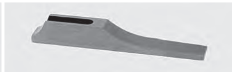
Kornsattel mit Längsprisma, ohne seitliche Rillen, flache Sichtfläche, kleines Modell. Radius: 7,5 mm; Breite: 8 mm; BH: 6,7 mm 12060-0000
