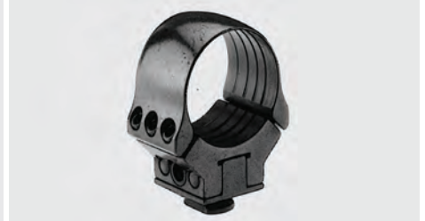
Vordere GK-Klemmringe in kurzer, besonders stabiler Ausführung, mit Toleranzausgleich. Der Klemmring sitzt in einer Aufnahme mit Pivotzapfen und wird mit drei Innensechskantschrauben geklemmt. Bauhöhe: 13,5 mm, Ringbreite: 22 mm
