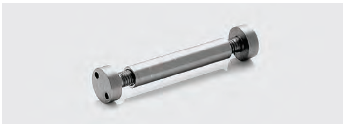
Zapfenlager für grosskalibrige Repetierbüchsen. Mittels der beiden Lochschrauben kann bei unterschiedlichen Schaftbreiten die Gewindebuchse so eingestellt werden, dass diese immer mittig sitzt.
