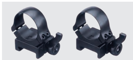
Aufkippmontage mit federnden Gegendruck-Klemmschiebern und schräggeteilten Ringen.
