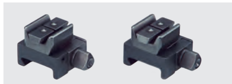
Aufkippmontage mit federnden Gegendruck-Klemmschiebern und 45°-Aufnahmeprismen.
