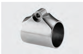
Magnum-Ringriemenbügel mit zylindrischer Aussenform, für Repetierbüchsen. Kopfbreite: 8 mm; Bohrung: ø 3,6 mm
