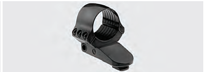
GK-Vorderringe mit Verlängerung. Der Klemmring sitzt in einer Verlängerung mit Pivotzapfen und wird mit zwei Innensechskantschrauben geklemmt. Mit Toleranzausgleich. Bauhöhe: 13,5 mm, Ringbreite: 22,0 mm
