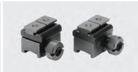
Aufkippmontage mit federnden, einstellbaren Gegendruck-Klemmschiebern für Swarovski SR-Zielfernrohre mit Innenschiene und Zahnprofil.
