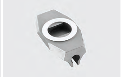
Schieneneneinsatz mit vorgefräster Aussenform und Drehkranz für Pivotzapfen. Form unten geschlossen. Für Drillinge Kaliber 12 und 16. Länge: 38 mm
