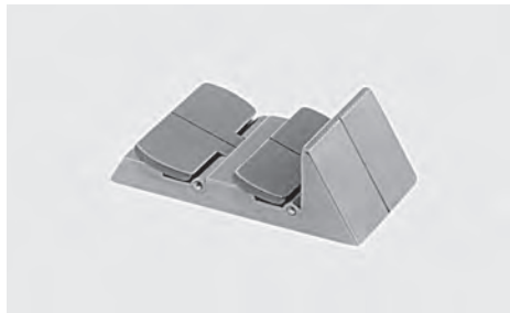
Super-Express-Visier mit zwei unterschiedlich hohen Klappen und Standvisier (Höhe 12 mm). Prisma 30° / Länge 36 mm / Breite 18 mm
