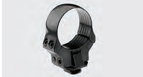
Vordere Klemmringe in kurzer Ausführung, mit Toleranzausgleich. Der Klemmring sitzt in einer Aufnahme mit Pivotzapfen und wird mit zwei Innensechskantschrauben geklemmt. Bauhöhe: 13,5 mm, Ringbreite: 15 mm
