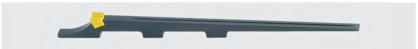
Drückjagdschiene in brüniertes Ausführung mit drei ausgefrästen Kammern zum Auflöten auf Repetierbüchsenläufe. Besonders vorteilhaft erweist sich neben der Visierhilfslinie die markante gelbe Kunststoff-Zielfindungshilfe mit Dreieckskimme. Länge: 222 mm; Breite: 8 mm
