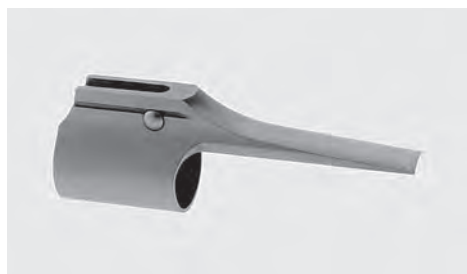
Masterpiece-Ringkornsattel mit Längsprisma, Kornschutz-Sicherung und Kornarretierung. Aus einem Stück gefertigt. Breite: 8,5 mm
