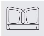
Fenstervisier mit einem roten Leuchtstreifen h = 2,0 mm
