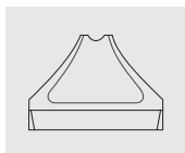
Inlayvisier mit grosser farbiger Kunststoffeinlage h = 1,0 mm
