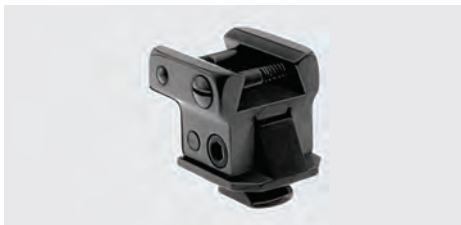
Vorderes 70°-Aufnahmeprisma in kurzer Ausführung, für Zielfernrohre mit Mittelrohrprisma. Mit Toleranzausgleich. Bauhöhe: 13,5 mm, Prismenlänge: 22,0 mm
