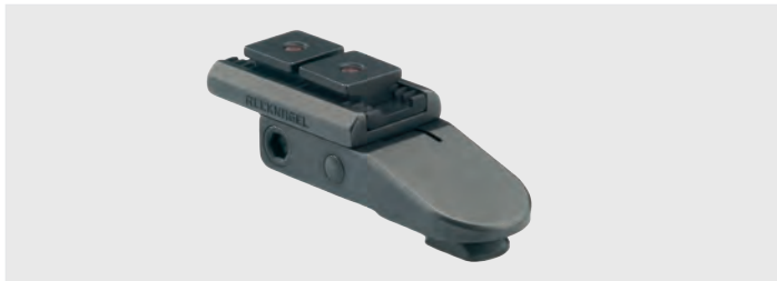
Vorderes Aufnahmeprisma, mit Verlängerung für Swarovski-SR. Mit Toleranzausgleich. Bauhöhe: 14 mm, Prismenlänge: 35 mm
