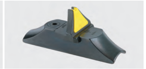
Visiereinheit bestehend aus Visiersattel mit grosser Klemmbacke, Schraube und Visier mit 16 mm Prisma. Der Visiersattel kann angeschraubt und/oder gelötet werden.
