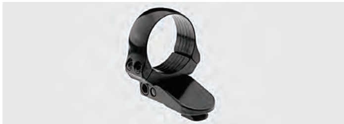
Vorderringe mit Verlängerung. Der Klemmring sitzt in einer Verlängerung mit Pivotzapfen und wird mit zwei Innensechskantschrauben geklemmt. Mit Toleranzausgleich. Bauhöhe: 13,5 mm, Ringbreite: 15,0 mm
