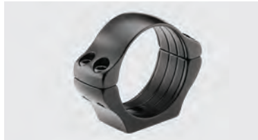
Hinterer Klemmring, Light-Ausführung, aus hochfestem Aluminium. Bauhöhe: 3,0 mm, Ringbreite: 15 mm
