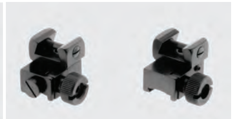
Aufkippmontage mit federnden, einstellbaren Gegendruck-Klemmschiebern u. 70°-Aufnahmeprismen für Zielfernrohre mit Mittelrohrschiene.
