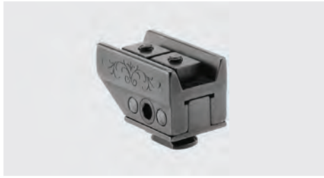
Vorderes Aufnahmeprisma, in kurzer Ausführung, für Zeiss-ZM-Zielfernrohre. Mit Toleranzausgleich. Bauhöhe: 14,0 mm, Prismenlänge: 35,0 mm
