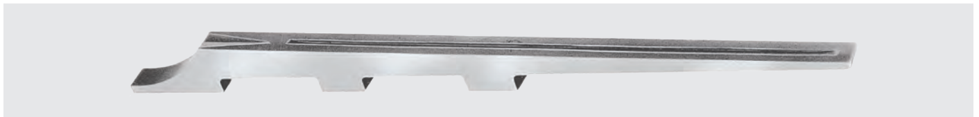
Drückjagdschiene mit Dreieckskimme, Visierhilfslinie und drei ausgefrästen Kammern zum Auflöten auf Repetierbüchsenläufe. Länge: 222 mm; Breite: 8 mm
