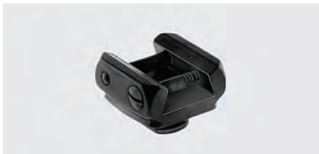
Vordere 70°-Aufnahmeprismen mit Pivotzapfen, ohne Toleranzausgleich. Für Zielfernrohre mit Prisma am Objektivrohr. Aus dem Vollen gefertigt. Prismenlänge: 22,0 mm
