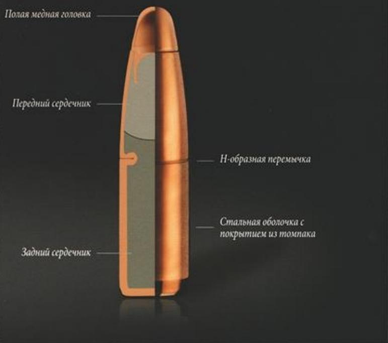
.... Полуболочка ведет себя точно так, как было задумано, как полуразрывная пуля. Головка разрывается, образуя осколки, остаток в форме цилиндра осуществляет пробивное действие.
